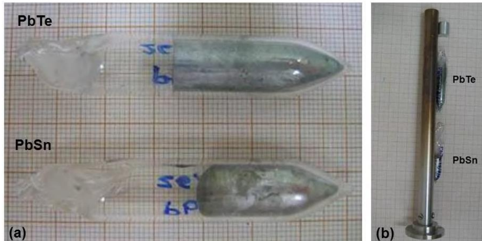
Figura 4 - (a) Liga de PbSn e PbTe solidificadas na operação Maracati II; (b) Porta amostras de segurança e posição relativa das amostras em seu interior (Bandeira et al, 2002).
